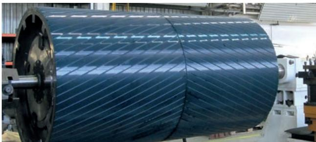
Trommelbeschichtung mit Polyurethan
